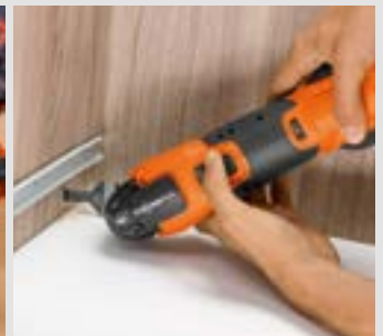
Kleinste Aussparungen ab 10 mm.
