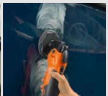
Entfernen von Kratzern in Fahrzeuglacken mit dem Filzpolierpad und Poliermittel.
