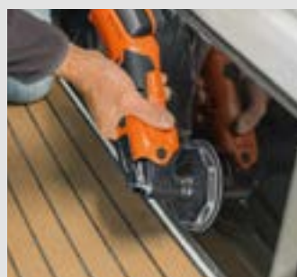
Schleifblätter mit Schaumstoff-Kaschierung zum Entfernen von Kratzern aus z. B. Acryl und Polycarbonat.
