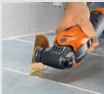
Mit den nur 1,2 mm breiten Sägeblättern lassen sich auch sehr schmale Fugen austrennen.
